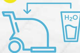
Gießen Sie Leitungswasser (keine Chemikalien!) in die Maschine.
