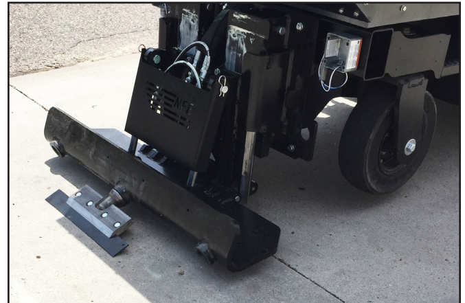
Verminderde meskantelhoek en verhoogd mes. Voorste zwenkwielen van de grond.
